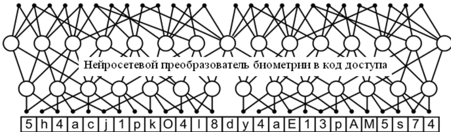
Нейросетевой преобразователь биометрии в код доступа
